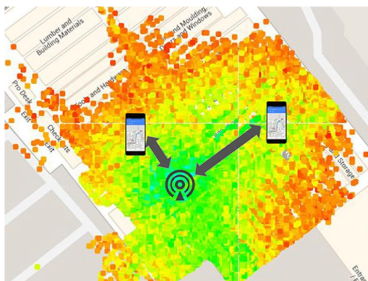
Slika 1.14. Prikaz snage WiFi signala u zavisnosti od relativne pozicije telefona u odnosu na pristupnu tačku
